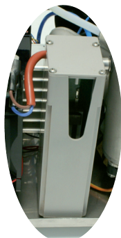
Retirez les 4 vis du couvercle du boîtier de l'élément céramique
