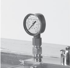
Vérifiez sur le manomètre que la pression d'alimentation ne soit ni trop basse, ni trop élevée. Le manomètre mesure la pression après le filtre et peut ainsi être utilisé pour surveiller l'état de filtre.
