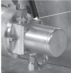
Déserez le bouchon de purge de un ou deux tours. Purgez la pompe jusqu'au moment où il n'y a plus d'air qui s'échappe, uniquement de l'eau.
