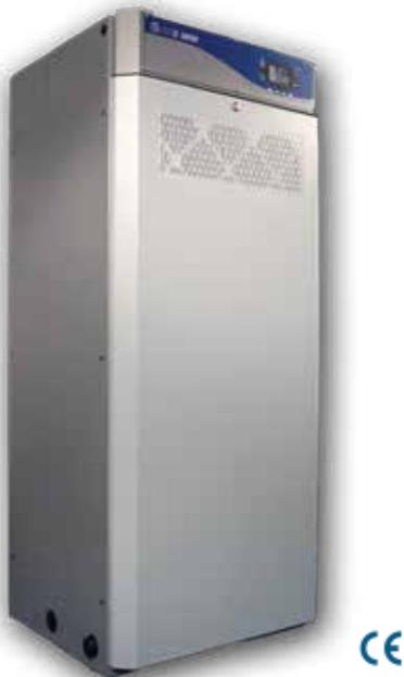
L'humidificateur au gaz SKGE3 de Nepronic utilise les dernières technologies pour produire de la vapeur. Lors d'une demande d'humidité, le ventilateur de combustion crée une pression négative à travers l'assemblage du venturi et de la vanne de gaz situé à l'entrée d'air. Le mélange de gaz et d'air est allumé sur le brûleur à gaz. Les produits de combustion circulent dans l'échangeur de chaleur submergé dans l'eau, chauffant ainsi l'eau dans la chambre d'évaporation pour produire de la vapeur.
