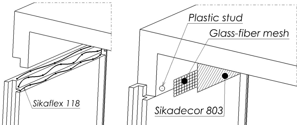
Pour terminer l'assemblage du bain de vapeur, vérifiez que tous les joints des pièces sont traités avec un filet en fibre de verre et du Sikadecor 803.
