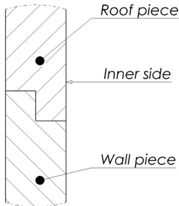
Joindre les pièces de plafond et les murs en appliquant Sikaflex .
