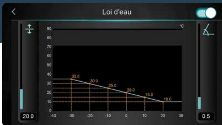
La pompe à chaleur ORIGIN choisit elle-même la température de départ d'eau nécessaire au chauffage du bâtiment en fonction de la température extérieure, via une loi d'eau entièrement réglable. Elle peut ainsi faire varier sa puissance de 30 à 100 % selon les besoins réels de chauffage. Cette fonction est idéale pour une maison équipée de radiateurs avec robinets thermostatiques ou plancher chauffant par exemple.
